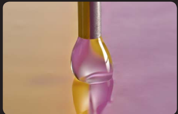
... auf zwei unabgebundene Light Body Materialien 40 Sek. nach Beginn des Mischens.
